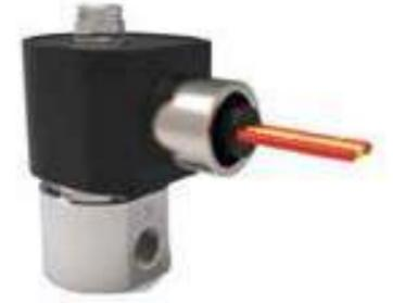
Нормально открытая версия электромагнитного клапана прямого действия серии 004 сочетает в себе преимущества высоких технических характеристик катушки и превосходных внутренних деталей. Когда на катушку подается напряжение электропитания, клапан этой версии закрывается при максимальном перепаде давления. Благодаря специальному уплотнительному материалу, этот клапан может использоваться в специальных средах, таких как гелий, водород и т.д.
