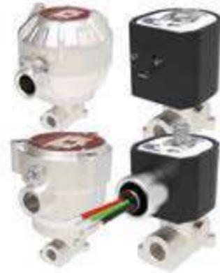
Электромагнитные клапаны серии 001, сочетающие в себе преимущества высоких рабочих характеристик катушки и превосходных внутренних деталей, представляют собой электромагнитные клапаны прямого действия и могут открываться без минимального рабочего давления. Двухходовые запорные клапаны для подачи управляющего воздуха, инертного газа, воды, масла и других газов/жидкостей, совместимых с используемым уплотнительным материалом.
